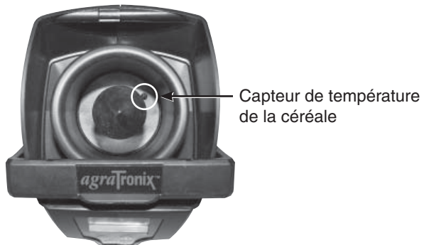
Figure 19. Capteur de température de la céréale
